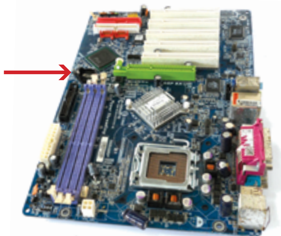
Esempio di allocazione della batteria tampone indicata dalla freccia.
